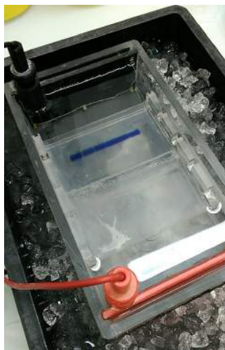
Abb. 7: Agarosegel unter Spannung im Eisbad.
